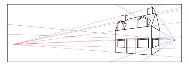
Trace the example to practice drawing a picture using 2 point perspective. 使用2点视角绘出上例图片。
